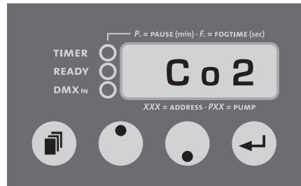
Fig. 3: Etat de l'afficheur pendant la phase de vidange du tuyau de raccord.
