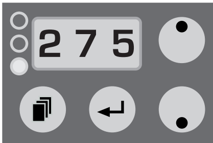
Abb. 2: Display-Anzeige bei Einstellen der DMX-Startadresse
