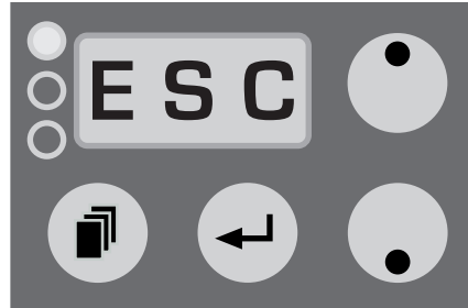
Escape zum Wechseln ins Standard-Menü mit Enter-Taste
