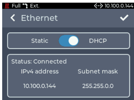
Abb. 27: Einstellung Ethernet - DHCP
