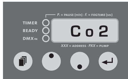
Abb. 3: Menü-Punkt zum Entfernen des restlichen CO2 aus dem Verbindungsschlauch
